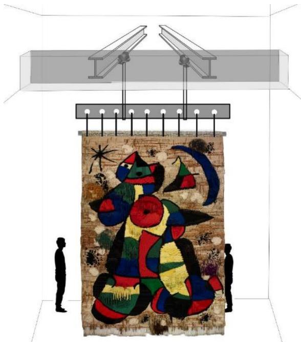
Una vez protegido el *Tapiz*, se han instalado dos vigas en el techo de la sala que han permitido el desplazamiento frontal de la obra, así como la estructura y las poleas que lo han sustentado durante la acción. El *Tapiz* se ha desplazado hacia adelante aproximadamente dos metros y se ha protegido también su dorso, para que pueda actuarse sobre la pared. Pese a ese desplazamiento, durante la restauración, la obra siempre ha podido verse desde la sala y el balcón.
